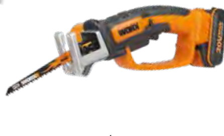
SERRUCHO MULTIFUNCIÓN WG894E WORX Batería: 20 V / 2,0 Ah. Velocidad en vacío: 2.200/min. Máxima capacidad de corte en madera: 60 mm. Máxima capacidad de corte en acero: 10 mm. Longitud de carrera: 16 mm. Tiempo de carga: 5 h. Peso: 1.3 kg. Cambio de hoja sin herramientas. Compatible con las hojas de sierra sable estándar. Herramienta de la plataforma Powershare.
