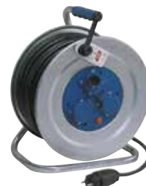
ENROLLACABLES TAYG Cable H05VV-F 3G 2,5 25 m. 3 bases 2P+T con termostato y tapa. Potencia máxima 250 V. 16 A. 4.000 W. Diámetro de carrete 255 mm. IP55.
