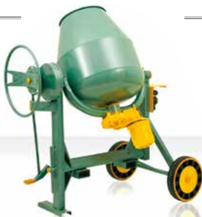
HORMIGONERA US-160 PLUS UMACON Hormigonera silenciosa. Idela para entornos con restricciones acústicas. 221 litros de cuba, 160 litros de mezcla. Motor de 1 HP.
