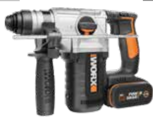
WX392 MARTILLO 4 FUNCIONES WORX 2,2 J 20 V 2 baterías (4 Ah + 4 Ah) Taladrado, taladrado con percusión neumática, cincelado (parada de giro) y selector de posición de cincel. Diseñado ergonómico. Portabrocas SDS-plus para cambio rápido de accesorios. Velocidad variable. Sistema de rotación reversible.
