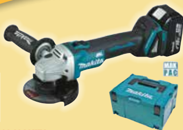
MINIAMOLADORA DGA454RMJ MAKITA Disco 115 mm. 18 V. 2 baterías BL1840, cargador rápido, protector de disco con cierre rápido, llave de pivotes, disco de desbarbe y maletín Makpac. Control automático de velocidad. Potente motor BL.
