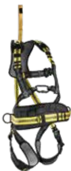
ARNÉS CON CINTURÓN STEELTEC PRO Con enganche dorsal y esternal con cinturón de posicionamiento y prolongador. Características: Arnés regulable con enganche dorsal y esternal y cinturón de posicionamiento regulable con anillas de sujeción laterales según EN358, con prolongador dorsal. Arnés de gran ergonomía, confort y versatilidad. Anilla dorsal y esternal acordes con la EN361. Espalda y piernas acolchadas. Anilla dorsal con prolongador. Hebillas automáticas en piernas.
