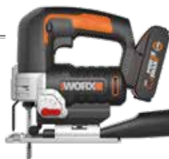
SIERRA DE CALAR PENDULAR A BATERIA WX543 WORX 20V 2,0Ah. Velocidad en vacío: 0-2.600/min. Longitud de carrera: 24 mm. Capacidad de corte: Madera 65 mm, Aluminio 18 mm, Acero 8 mm. Corte a bisel: 0-45°. Tiempo de carga: 1 h. Peso de la máquina: 1,82 kg.
