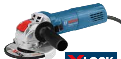
MINIAMOLADORA GWX 750 BOSCH 750 W. 11.000 r.p.m. Disco de 115 mm. Protección contra re-arranque. Caperuza protectora anti-torsión.
