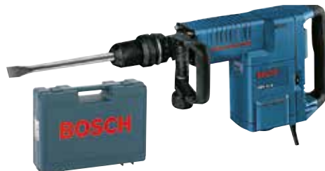
MARTILLO PICADOR GSH 11 E SDS MAX BOSCH 1.500 W. 16,8 J. SDS-max. Electrónico. Incluye maletín. Indicador de desgaste de escobilla. 1 cincel.
